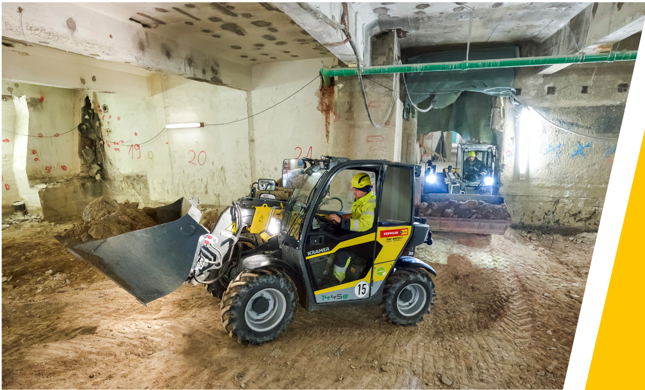
Dank einer Teleskopfunktion sind Überkopfarbeiten mit dem E-Teleskoplader 1445e problemlos möglich
