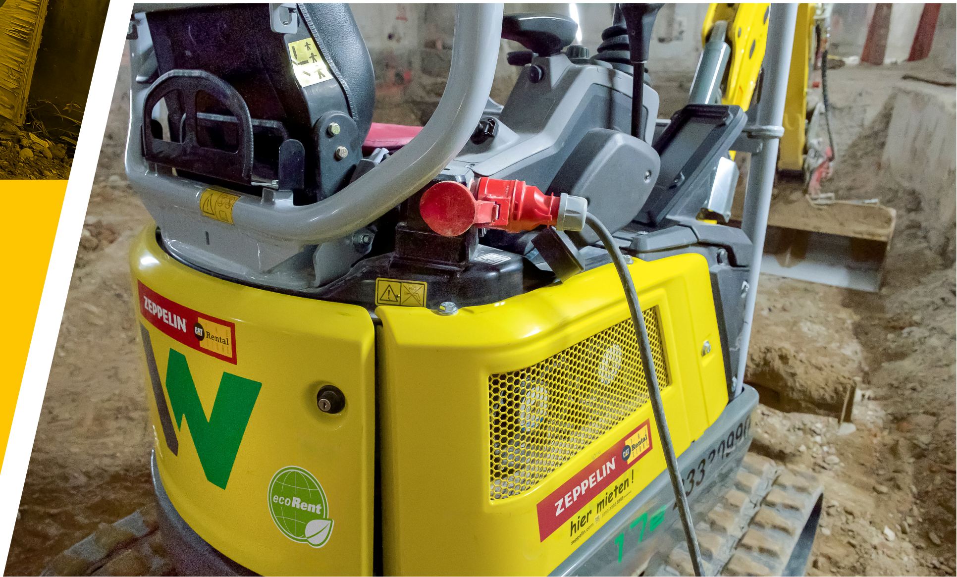
Der Minibagger EZ17e kann während des Betriebs an einem festen Standort geladen werden
